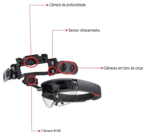
Figura 1 – Microsoft Hololens e seus sensores.
