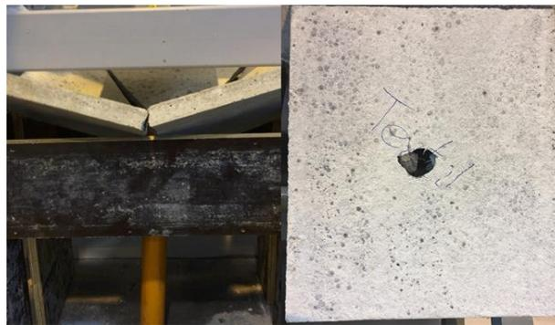
Figura 5 – Placas após o ensaio de corpo rígido.
