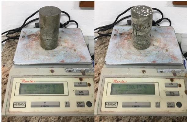
Figura 3 – Pesagem dos corpos de prova.
