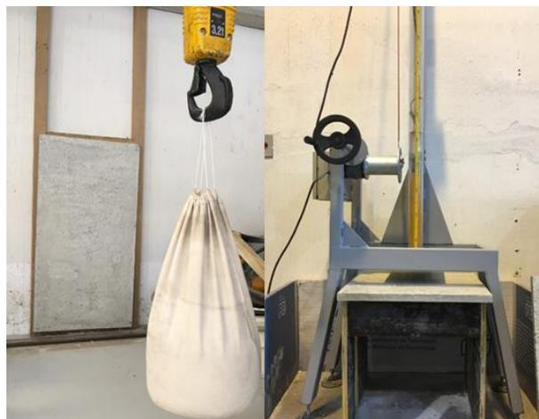
Figura 2 – Aparatos dos ensaios de corpo mole e rígido.
