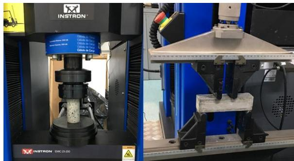
Figura 1 – Equipamento ensaio de compressão e flexão.
