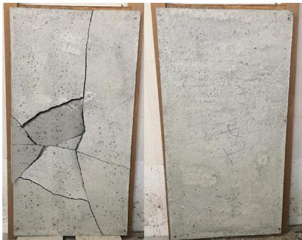
Figura 4 – Placas após o ensaio de corpo mole.
