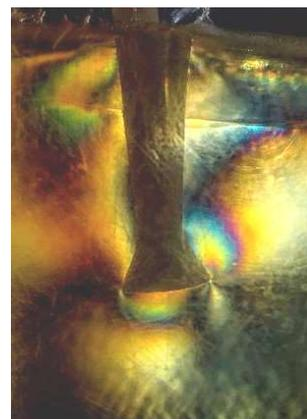
Figura 8 - Bulbo de tensões na prova de carga horizontal em tubulão curto
