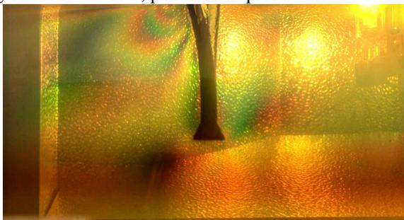
Figura 7 - Bulbo de tensões na prova de carga horizontal em tubulão profundo
