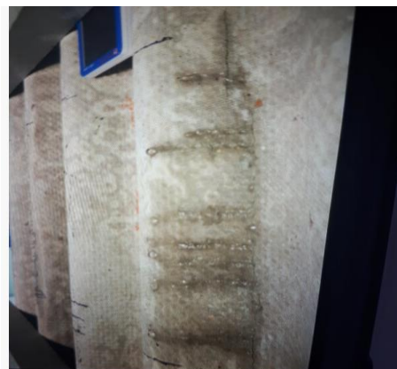
Figura 4 – Ensaio de permeabilidade.
