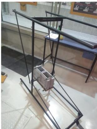
Figura 2 – Bloqueira (Molde para os blocos de encaixe)
