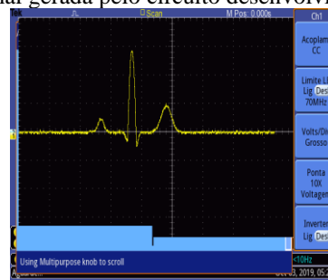
Figura 4 – Onda ECG normal gerada pelo circuito.
