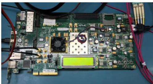
Figura 1 – Placa FPGA utilizada para realizar testes. Modelo Xillinx KC705.
