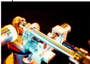
Figura 1 – Plunger acoplada a canalização 30°A do acelerador Pelletron
