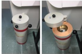
Figura 5: Detector de raios gama do Laboratório de Física das Radiações do Centro Universitário FEI.
