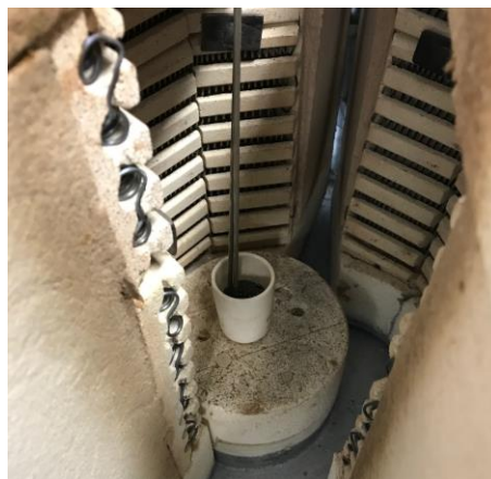
Figura 2 – Montagem utilizada para os experimentos com baixa velocidade de resfriamento.
