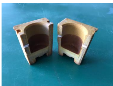
Figura 1 – Copo utilizado para análise térmica em alta velocidade de solidificação.
