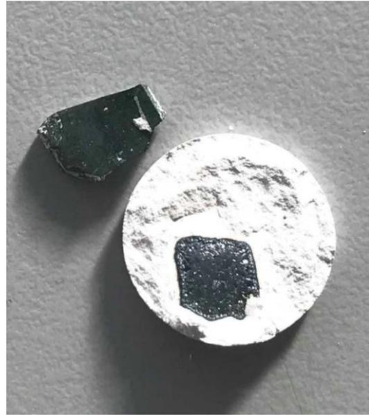
Figura 7: Oxidação da amostra Fe-Cr no briquete de caulim
