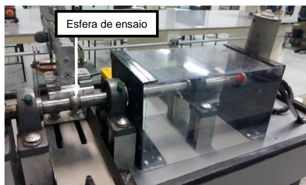
Figura 2 – Equipamento “ball-cratering” utilizado nos ensaios tribológicos de micro-abrasão.
