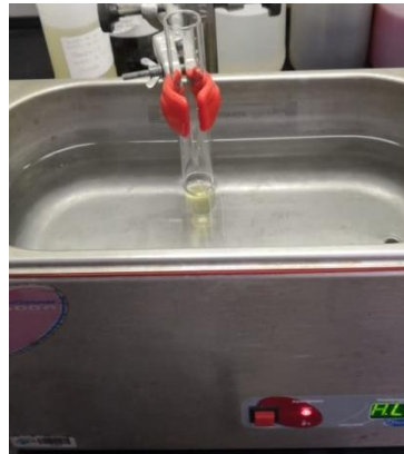
Figura 1 – Produção em batelada de biodiesel
