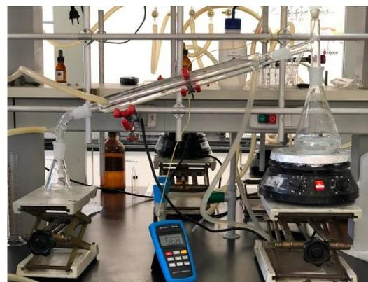
Figura 2 - Sistema de Cristalização por Evaporação
