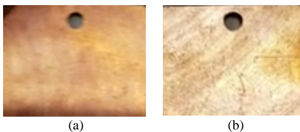
Figura 1 – Superfície do cobre após ensaios de perda de massa em biodiesel de soja metílico na ausência e presença do extrato do caroço do abacate por 120 h de imersão a temperatura ambiente. a) Cobre em biodiesel sem a presença do extrato e b) Cobre em biodiesel com 1000 ppm do extrato
