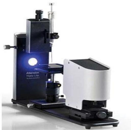
Figura 1: Theta Lite da Biolin Scientific, na qual foi realizado os ensaios
