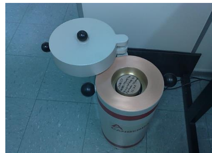
Figura 2 – Blindagem de chumbo contendo o detector de NaI e um pote com solo. O detector recebe o sinal das radiações gama emitidas pela amostra, e fornece um espectro de emissões em função da energia.
