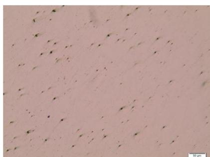
Figura 3 – Microestrutura da liga 253 MA sem tempo de uso. 100x.
