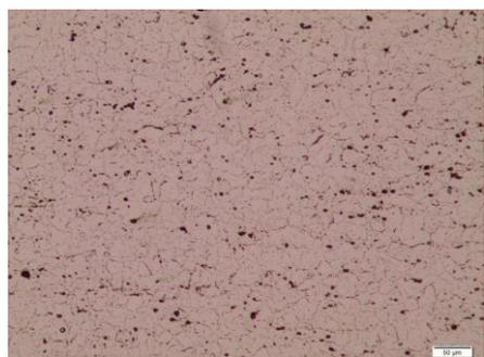
Figura 2 – Microestrutura da liga AISI 446 sem tempo de uso. 100x.
