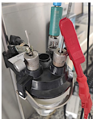
Figura 1 – Exemplicação do sistema utilizado para a realização dos testes potenciométricos
