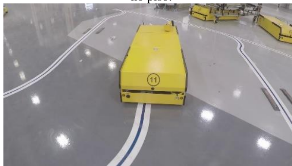
Figura 6: Exemplo de AGV guiado por linhas pintadas no piso.
