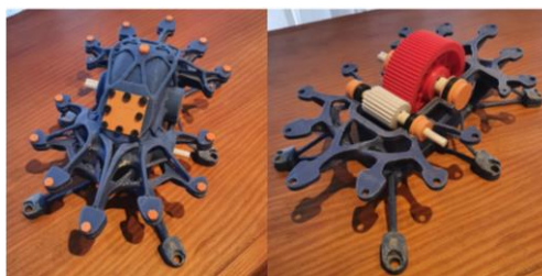
Figura 7 – Prototipação do redutor após o DG
