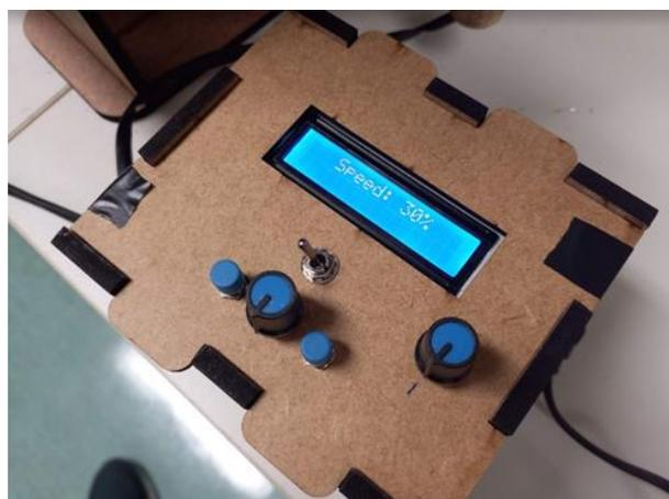
Figura 2 – Caixa de automação responsável pelo controle dos motores.
