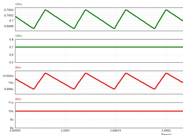
Figura 3 – Formas de onda da tensão e da corrente sobre o Resistor de Carga ( $R_o$ ), com diodo real.
