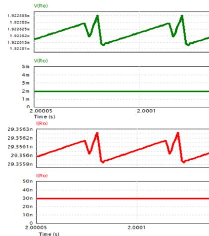
Figura 4 – Formas de onda da tensão e da corrente sobre o Resistor de Carga ( $R_o$ ), com diodo e transistor real.
