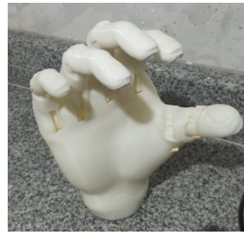
Figura 5 – Prótese 3D impressa que replica a forma da mão humana.
