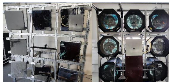
Figura 2 – Disposição dos espelhos colimados (esquerda) e lâmpadas de xênon (direita).
