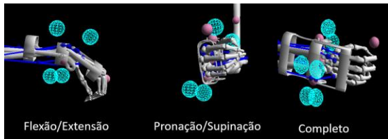
Figura 3 - Conexão da órtese por esferas de contato Fonte: Autor
