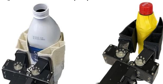
Figura 2 – Garras do robô fazendo esforços diferentes.
