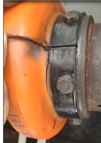
Figura 5 - Acoplamento rachado no caso de desbalanceamento
