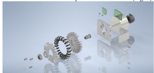
Figura 3 – Módulo da Transmissão – Vista Explodida
