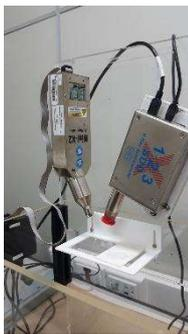
Figura 3 – Sistema utilizado para a realização do estudo formado por um sensor semicondutor de Si e o Tubo de raios X de Ag. Fonte: autor.
