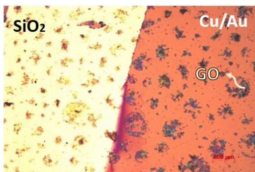
Figura 2 – Amostra 68 das trilhas de SiO 2 com 100x de ampliação
