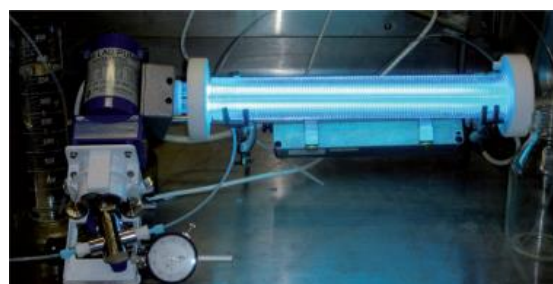
Figura 6 – Reator de fluxo contínuo (Su et al. , 2014).
