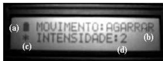
Figura 3: Display LCD de interface, onde o usuário pode obter informações do status atual do sistema: a) Nível de carga da bateria - b) Movimento selecionado - c) Indicador de movimento travado - d) Nível de intensidade de estimulação.
