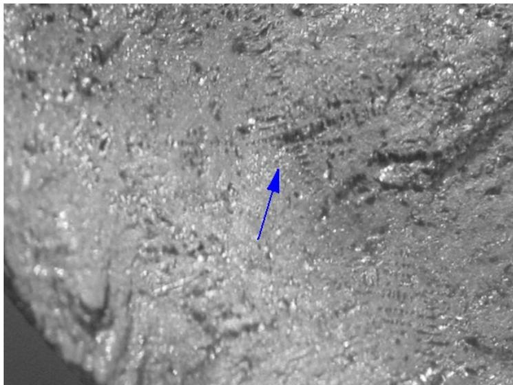
*Figura 39: Superfície de fratura de um corpo-de-prova que sofreu carregamento cíclico com amplitude de deformação igual a 0,15 %. A seta indica porosidade interdendrítica.*
