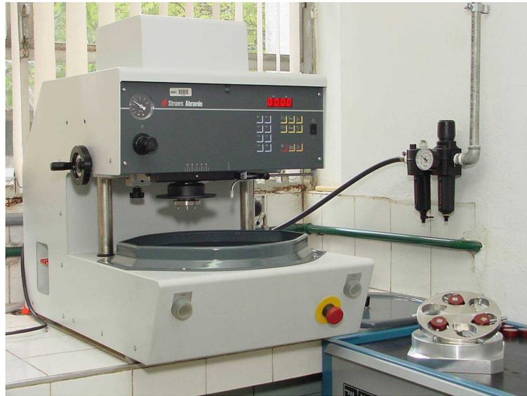
*Figura 22: Politriz automática Abramin Struers – LabMat/FEI.*
