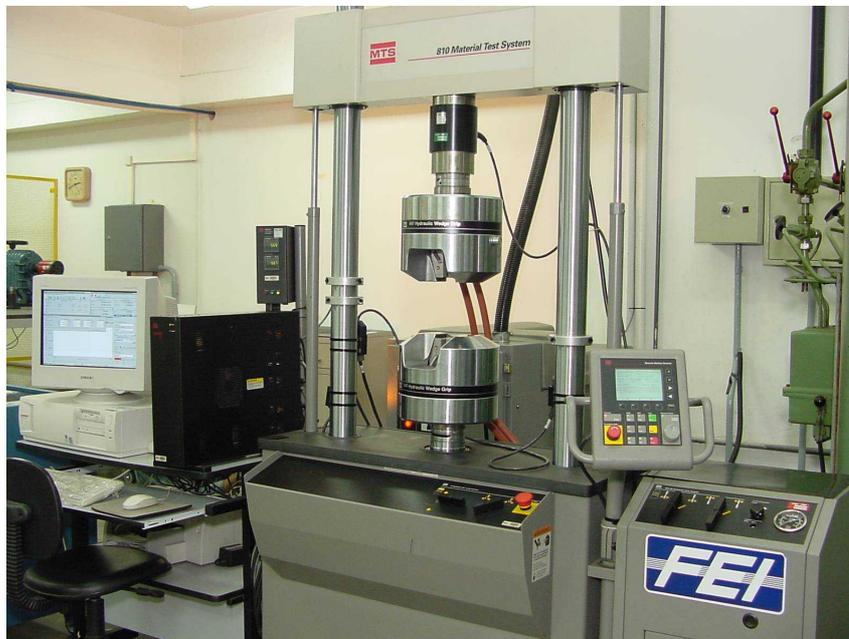
*Figura 24: Máquina universal de ensaios MTS-LabMat/FEI.*
