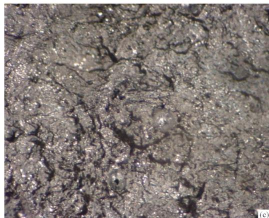
*Figura 37: Superfície de fratura de um corpo-de-prova que sofreu carregamento cíclico com amplitude de deformação igual a 0,175 %. Em (c), detalhe das porosidades devido à presença de gás hidrogênio.*
