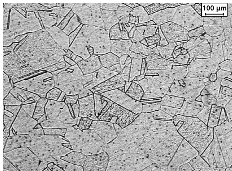
Figura 19: Micrografia do aço inoxidável austenítico UNS S30100 solubilizado 30 min a 1200 °C atacado eletroliticamente por 60 segundos. (50x)
