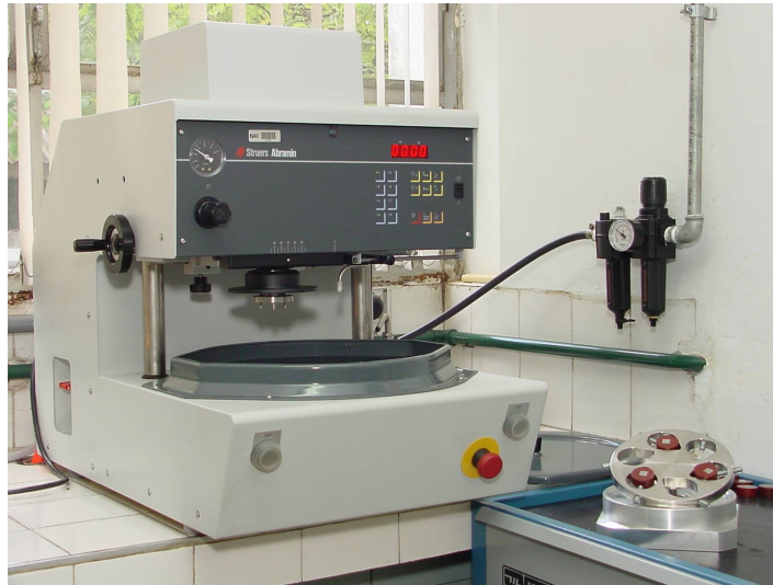
Figura 14: Máquina STRUERS ABRAMIN utilizada para os procedimentos de lixamento e polimento automático dos corpos-de-prova. LabMat-FEI
