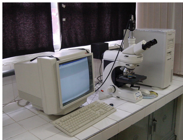
Figura 16: Microscópio LEICA DMLM e analisador de imagens. LabMat-FEI
