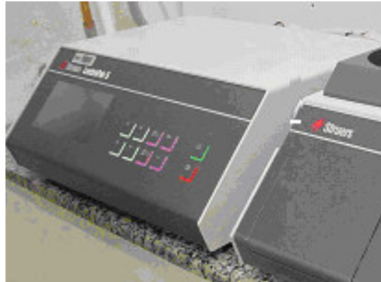
Figura 15: STRUERS LECTROPOL-5, utilizada para ataque eletrolítico dos corpos-de-prova. LabMat-FEI
