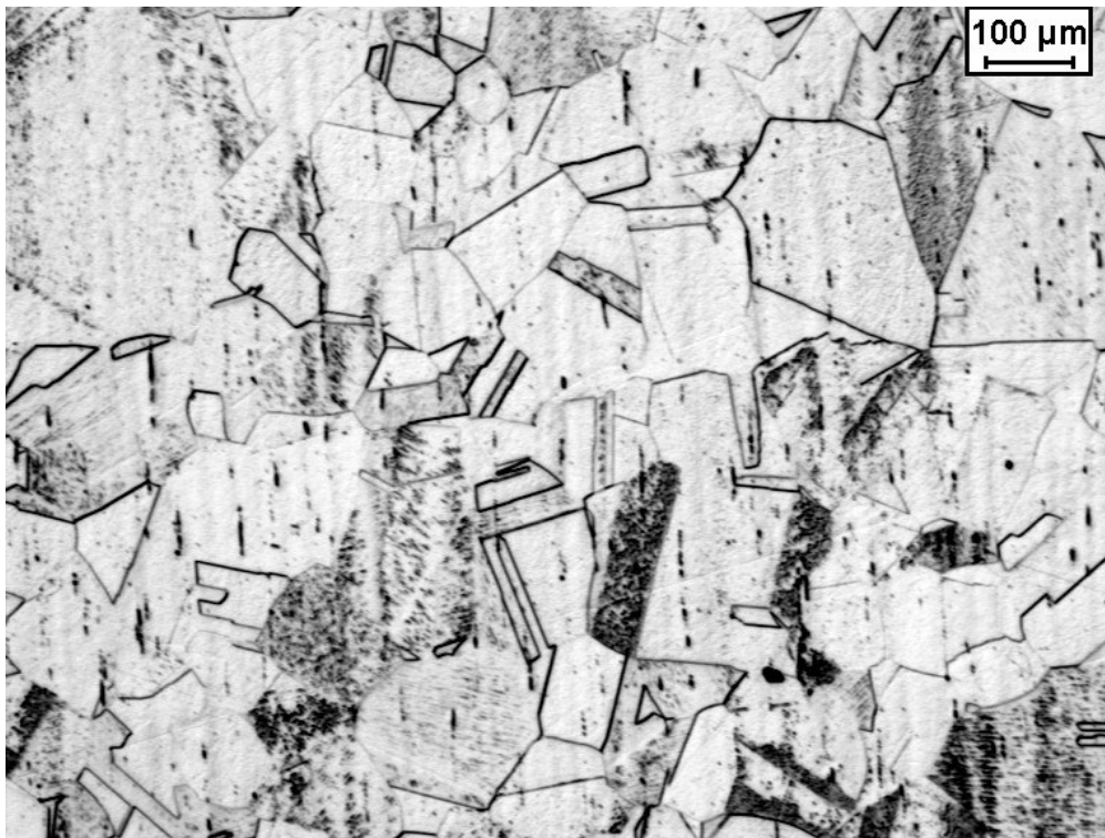
Figura 14 - Micrografia da amostra de aço inoxidável UNS30100 submetida ao ataque eletrolítico com ácido oxálico por 30 segundos mostrando os contornos de grão e de macla do material tratado por 0,5 hora a 1200°C.
