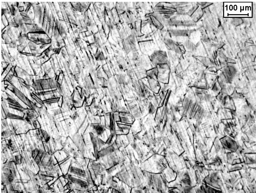
Figura 13 - Micrografia da amostra de aço inoxidável UNSS30100 submetida ao ataque eletrolítico com ácido oxálico por 30 segundos mostrando os contornos de grão e de macla do material original.
