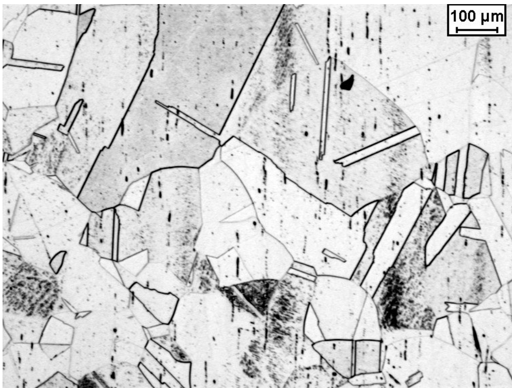
Figura 15 - Micrografia da amostra de aço inoxidável UNS30100 submetida ao ataque eletrolítico com ácido oxálico por 30 segundos mostrando os contornos de grão e de macla do material tratado por 1 hora a 1200°C.
