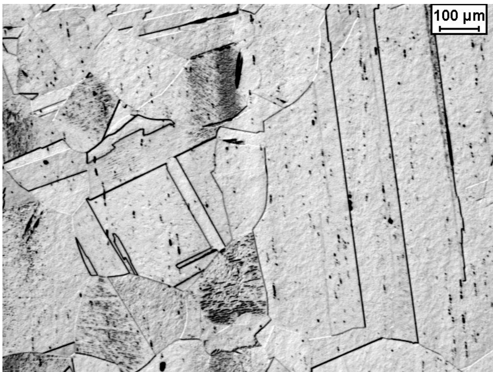
Figura 17 - Micrografia da amostra de aço inoxidável UNS30100 submetida ao ataque eletrolítico com ácido oxálico por 30 segundos mostrando os contornos de grão e de macla do material tratado por 6 horas a 1200°C.
