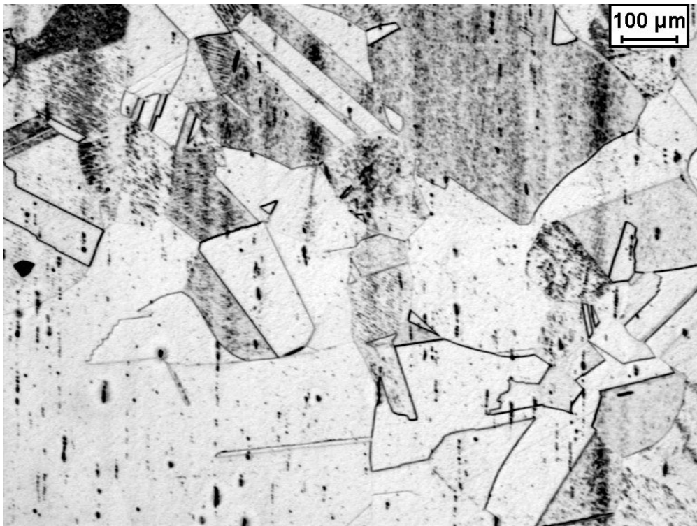
Figura 16 - Micrografia da amostra de aço inoxidável UNS30100 submetida ao ataque eletrolítico com ácido oxálico por 30 segundos mostrando os contornos de grão e de macla do material tratado por 2 horas a 1200°C.
