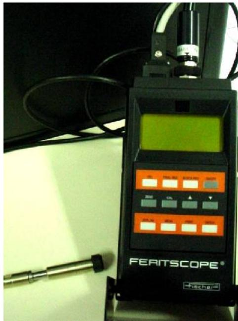
*Figura 3.5: Ferritoscópio FISCHER do LabMat-FEI.*
