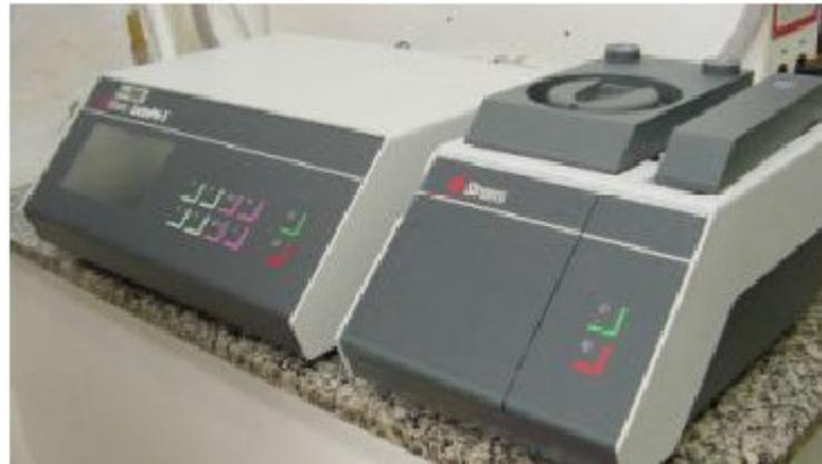
**Figura 3.4: Máquina Struers Lectropol do LabMat-FEI.**
