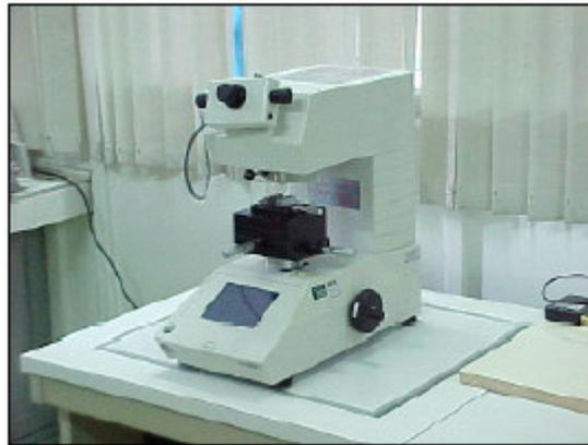
**Figura 3.6: Microdurômetro SHIMADZU do LabMat-FEI.**
