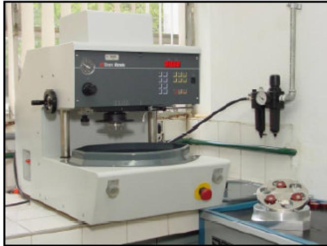
*Figura 3.2: Máquina Struers Abramim do LabMat-FEI.*
