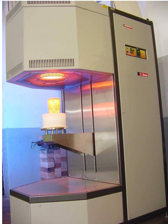
**Figura 3.1: Forno Carbolite BFL do LabMat-FEI.**
