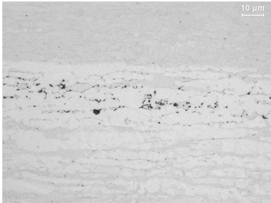
*Micrografia 4.4: Amostra de aço SAF 2205 envelhecido por 1min a 850°C.
