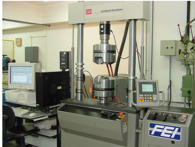
Figura 3.7: Máquina universal de ensaios MTS, com capacidade máxima de 250 kN, servo-controlada. LabMat-FEI
