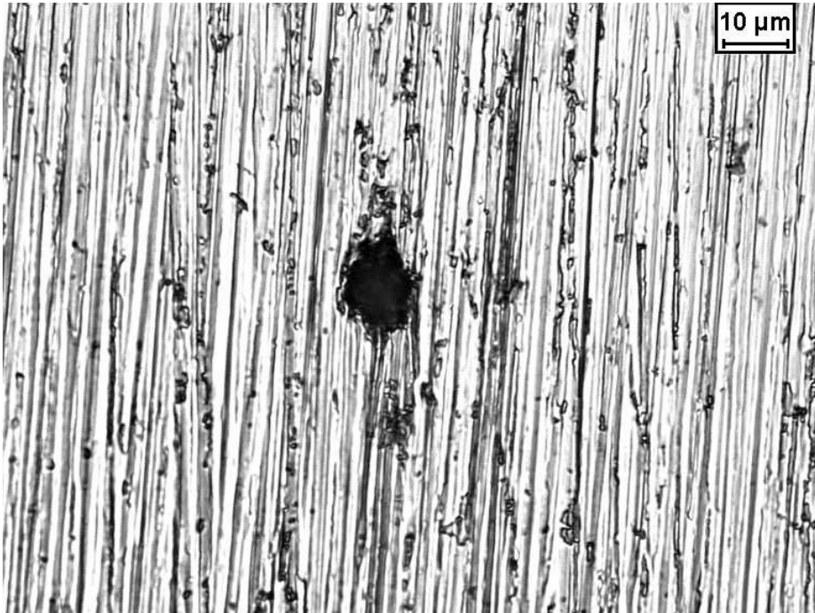
Micrografia 4.13: Superfície da amostra após polarização cíclica em 0,1 M NaCl + 0,5 M NaBr.
