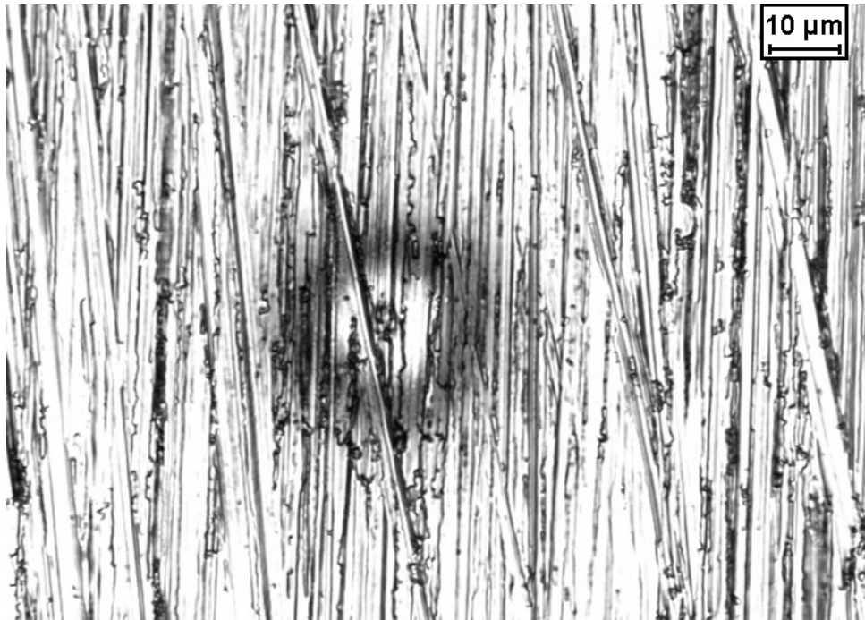
Micrografia 4.11: Superfície da amostra após polarização cíclica em 0,2 M NaCl + 0,4 M NaBr.
