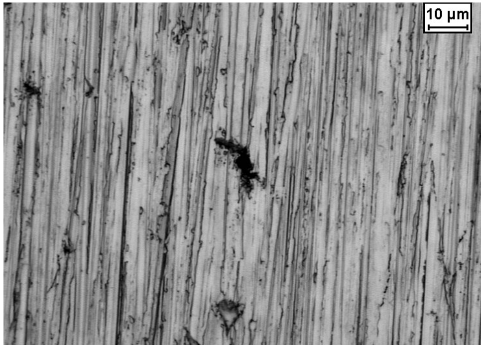
Micrografia 4.3: Superfície da amostra após polarização cíclica em 0,6 M NaCl.
