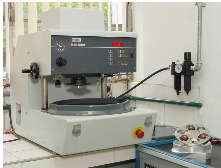
Figura 8: Máquina STRUERS ABRAMIN utilizada para os procedimentos de lixamento e polimento automático dos corpos-de-prova. LabMat-FEI
