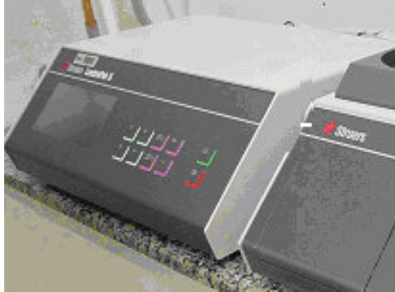
Figura 10: STRUERS LECTROPOL-5, utilizada para ataque eletrolítico dos corpos-de-prova. LabMat-FEI
