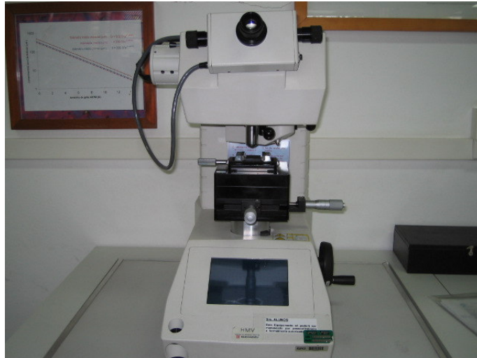
Figura 9: Microdurômetro SHIMADZU HMV-2 utilizado para a medição de dureza dos corpos-de-prova. LabMat-FEI
