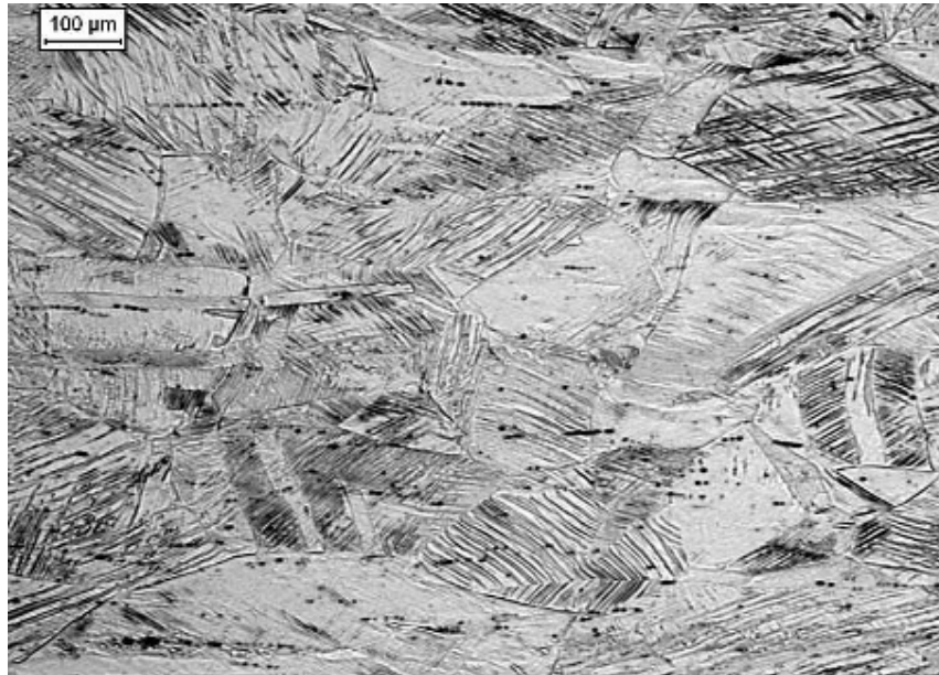
Micrografia 5. Amostra com 30% de deformação por tração uniaxial à temperatura ambiente.
