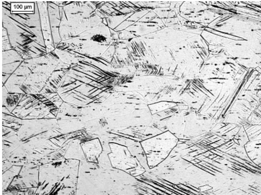
Micrografia 3. Amostra com 10% de deformação por tração uniaxial à temperatura ambiente.
