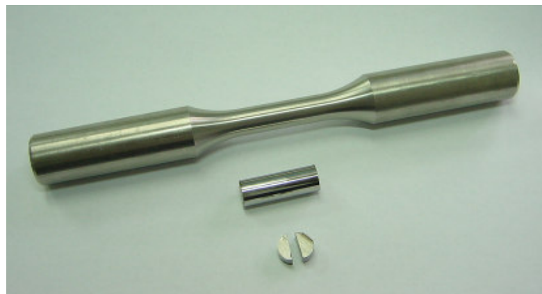
Figura 18. Etapas de preparação dos corpos-de-prova: corte na seção longitudinal do corpo-de-prova de tração.
