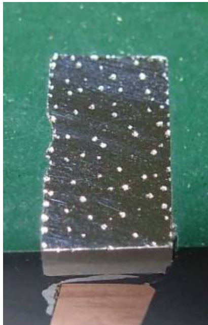
Figura 47. Detalhe destacado em vermelho da figura 46 mostrando alta densidade de pites na amostra após ensaio de polarização potenciodinâmica.
