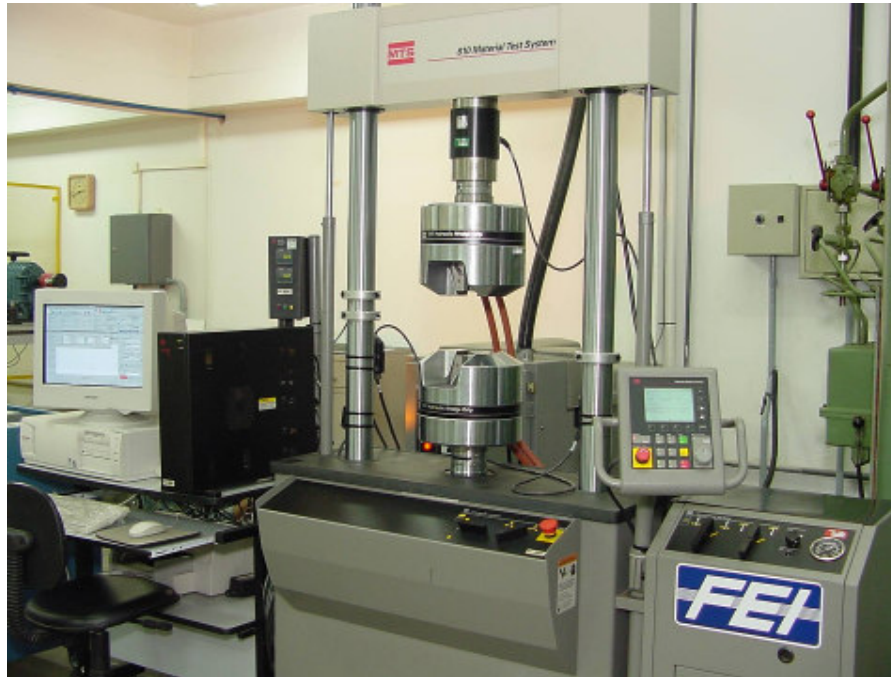
Figura 16. Máquina universal de ensaios (MTS 810.25) do Laboratório de Materiais Metálicos do Centro Universitário da FEI.
