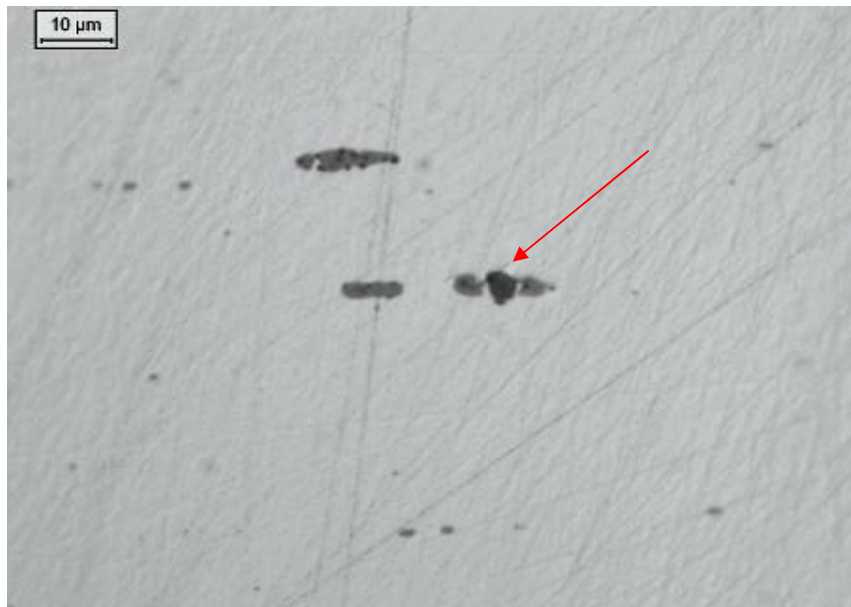
Micrografia 27. Pite (indicado pela seta) se formando em inclusão (cinza clara) - amostra de 38% deformação após polarização potenciodinâmica em solução 0,1M NaBr.
