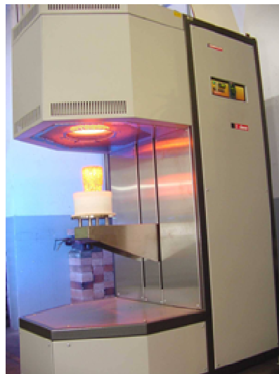
Fotografia 4: Forno para fundição e tratamentos térmicos para até 1800 °C, utilizando controladores por relê de estado sólido, com retorta de 7,8 L de capacidade.
