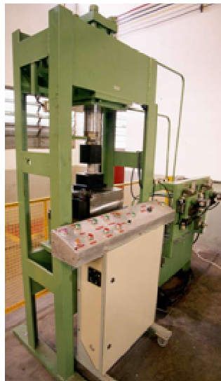
Fotografia 1: Prensa hidráulica de duplo efeito de 40 ton de capacidade máxima, com matriz de briquetagem.
