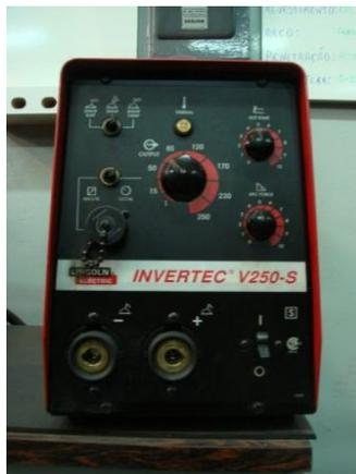
Figura 6 - Máquina de solda Invertec V250-S da Lincoln Electric, do CLM-FEI.
