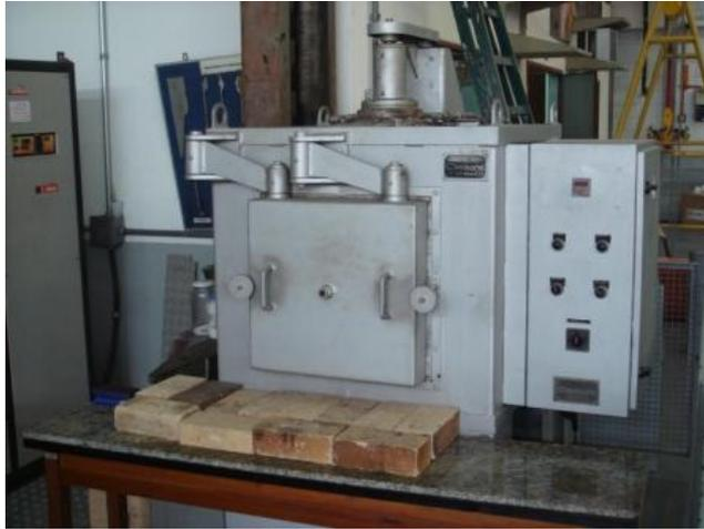
Figura 5 - Forno Mufla do Centro de Desenvolvimento de Materiais Metálicos (CDMatM) do Centro Universitário da FEI.
