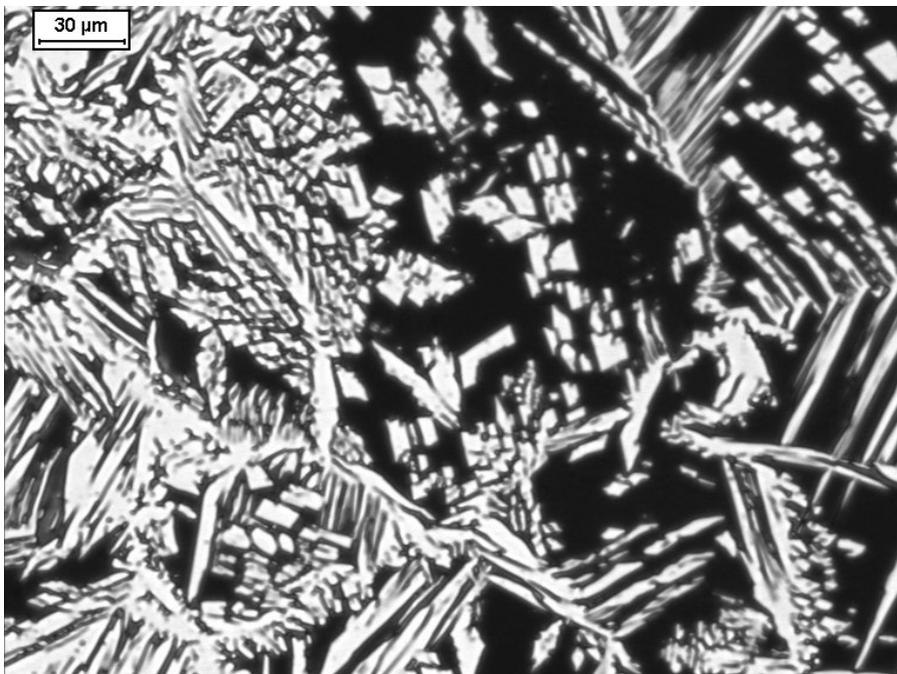
Micrografia 4. Amostra apresentando a fase de transição entre zona termicamente afetada pelo calor e a região do metal de adição. Ferrita (escura) e austenita (cinza). Ataque: Behara modificado.
