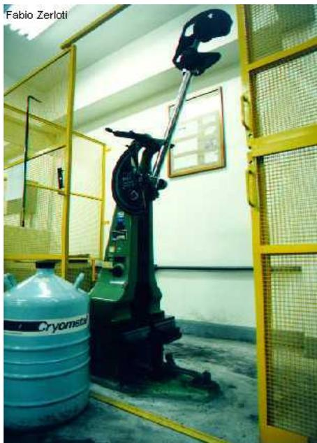
Figura 17 – Máquina de ensaio de impacto Charpy com capacidade máxima de 300J, do Centro de Desenvolvimento de Materiais Metálicos do Centro Universitário da FEI.
