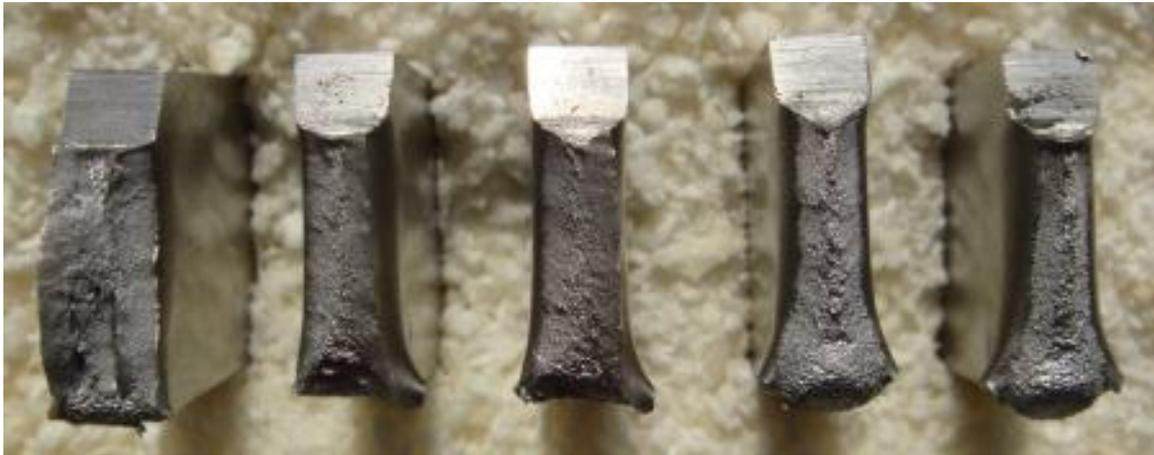
Figura 27 - Fraturas do metal base à  $-196^{\circ}\text{C}$ ,  $-73^{\circ}\text{C}$ ,  $-30^{\circ}\text{C}$ ,  $21^{\circ}\text{C}$ ,  $70^{\circ}\text{C}$ .
