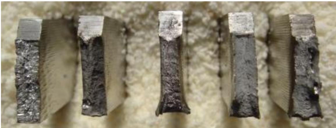
Figura 28 - Fraturas do metal de adição à  $-196^{\circ}\text{C}$ ,  $-73^{\circ}\text{C}$ ,  $-30^{\circ}\text{C}$ ,  $21^{\circ}\text{C}$ ,  $70^{\circ}\text{C}$ .
