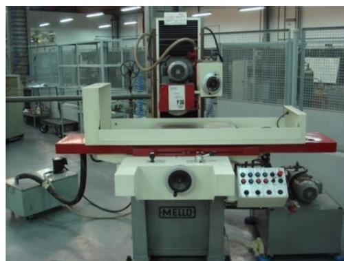
Figura 9 - Retificadora Plana de Precisão Mello do CLM-FEI.
