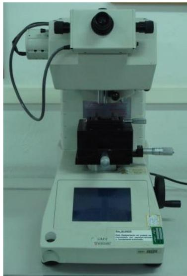
Figura 15 - Microdurômetro Shimadzu HMV-2. CDMatM-FEI
