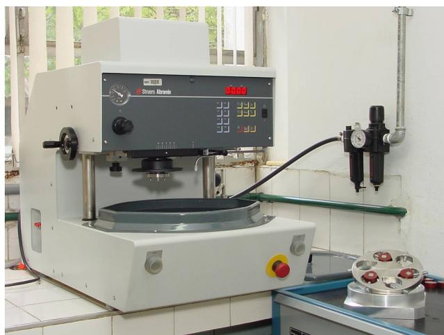
Figura 13 - Máquina STRUERS ABRAMIN utilizada para os procedimentos de lixamento e polimento automático dos corpos-de-prova. CDMatM-FEI.
