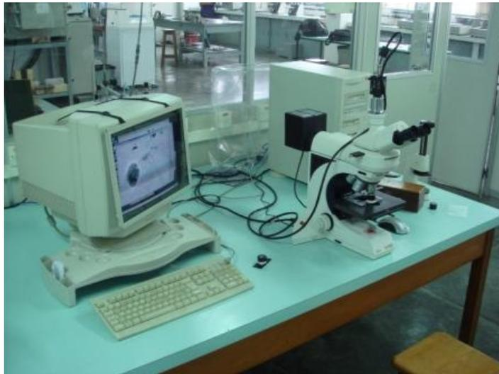
Figura 14 - Microscópio LEICA DMLM e analisador de imagens. CDMatM-FEI
