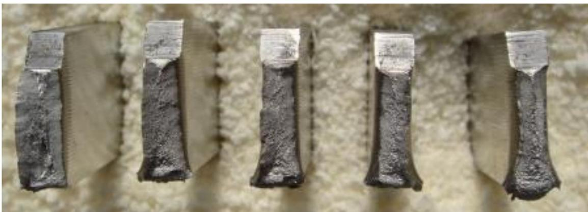
Figura 29 - Fraturas da ZTA à  $-196^{\circ}\text{C}$ ,  $-73^{\circ}\text{C}$ ,  $-30^{\circ}\text{C}$ ,  $21^{\circ}\text{C}$ ,  $70^{\circ}\text{C}$ .
