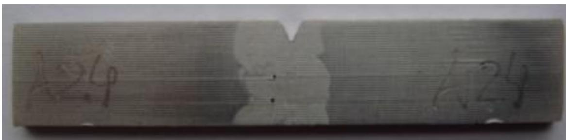
Figura 19 – Corpo-de-prova com o entalhe localizado no metal de adição.
