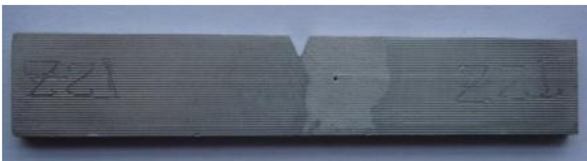
Figura 18 – Corpo-de-prova com o entalhe localizado na ZTA.
