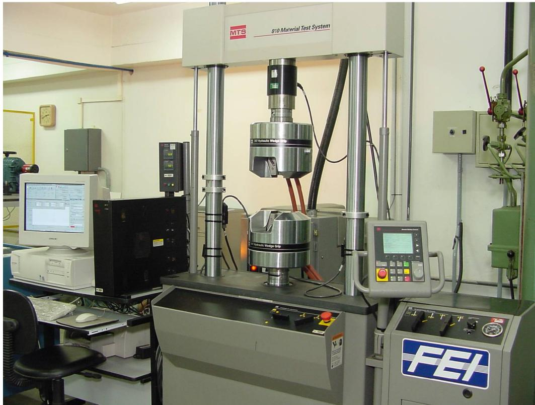
Figura 10: máquina de ensaios MTS. CDMatM-FEI.
