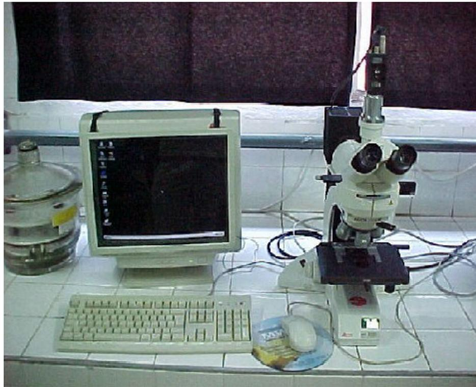
Figura 9: microscópio óptico LEICA DMLM. CDMatM-FEI.
