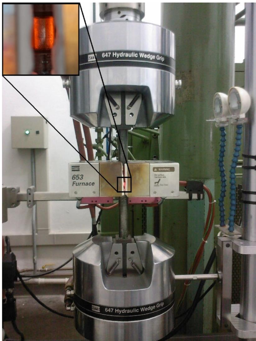
Figura 11: máquina de ensaios MTS do CDMatM-FEI com aparato para a realização dos ensaios a quente.
