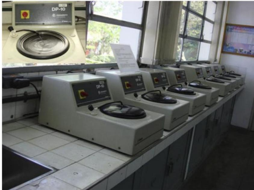
Figura 7: lixadeiras mecânicas de 220#, 320#, 400# e 600#, respectivamente. CDMatM-FEI.
