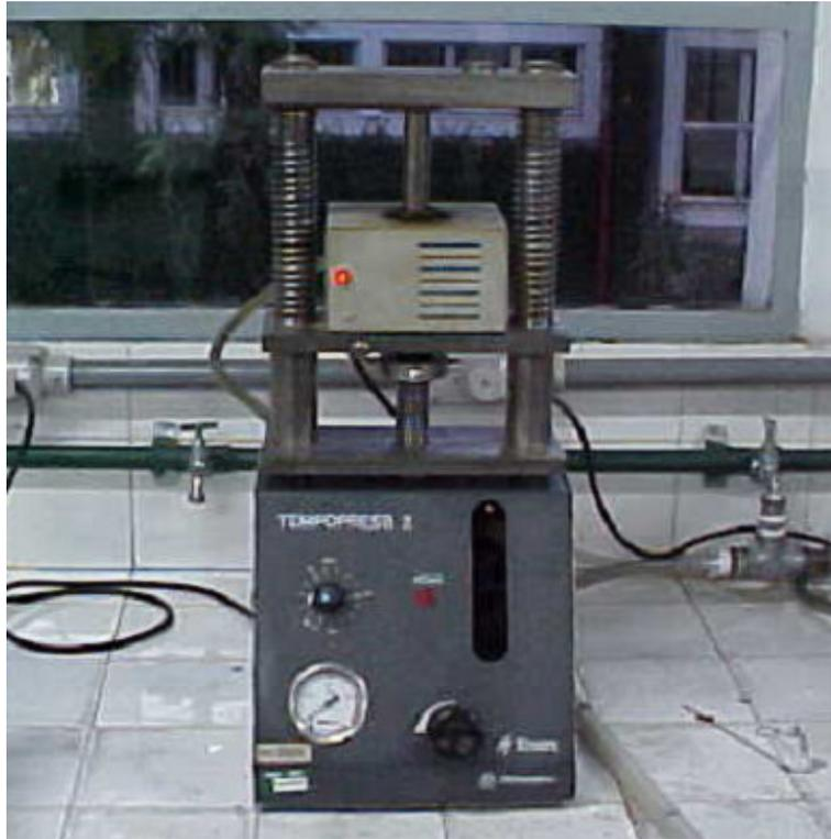
Figura 6: prensa de embutimento metalográfico. CDMatM-FEI.
