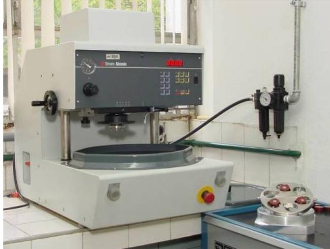
Figura 11 - Máquina STRUERS ABRAMIN utilizada para os procedimentos de lixamento e polimento automático dos corpos-de-prova. CDMatM-FEI.
