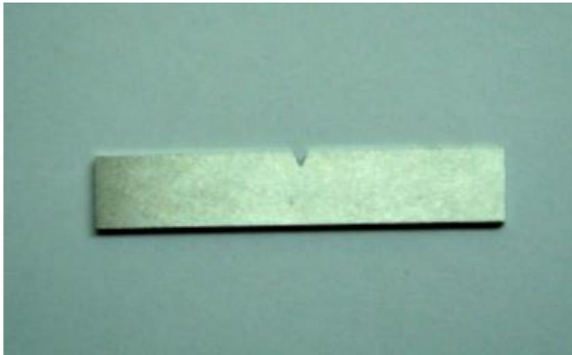
Figura 14 – Corpo-de-Prova do ensaio Charpy.
