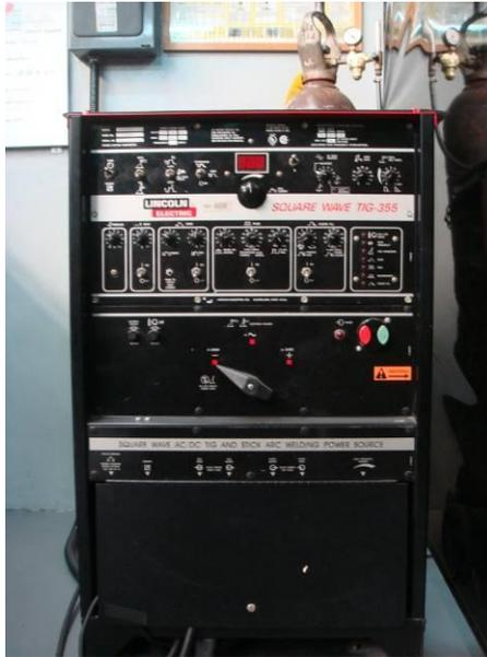
Figura 9- Máquina de solda Square Wave TIG-355 da Lincoln Electric, do CLM-FEI.
