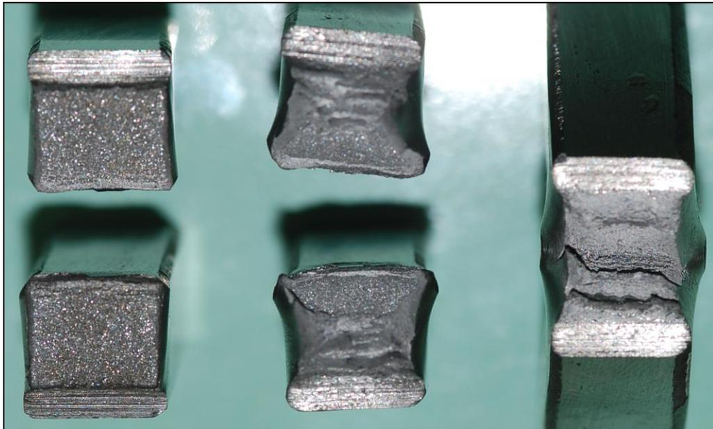
Figura 2 - Foto das superfícies de fratura, de aço baixo carbono, corpos-de-prova segundo o ensaio Charpy com entalhe em V. (MAGNABOSCO, 2009).
