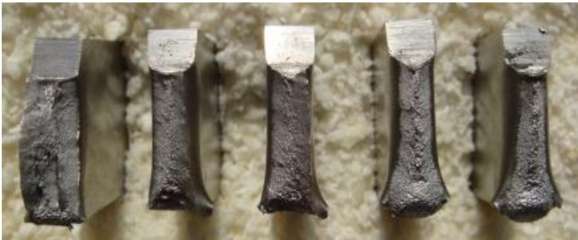
Figura 28 – Fraturas do entalhe localizado no metal base à  $-196^{\circ}\text{C}$ ,  $-73^{\circ}\text{C}$ ,  $-30^{\circ}\text{C}$ ,  $21^{\circ}\text{C}$ ,  $70^{\circ}\text{C}$ .
