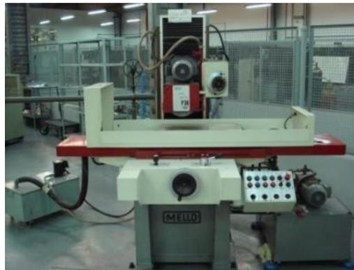
Figura 16 - Retificadora Plana de Precisão Mello do CLM-FEI.
