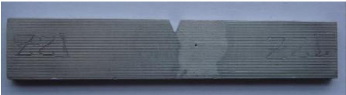
Figura 19 – Corpo-de-prova com o entalhe localizado na ZTA.
