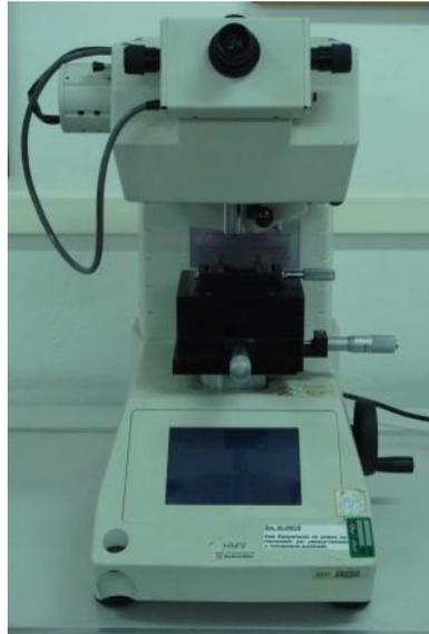
Figura 13 - Microdurômetro Shimadzu HMV-2. CDMatM-FEI
