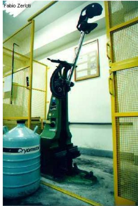
Figura 21 – Máquina de ensaio de impacto Charpy com capacidade máxima de 300J, do Centro de Desenvolvimento de Materiais Metálicos do Centro Universitário da FEI.
