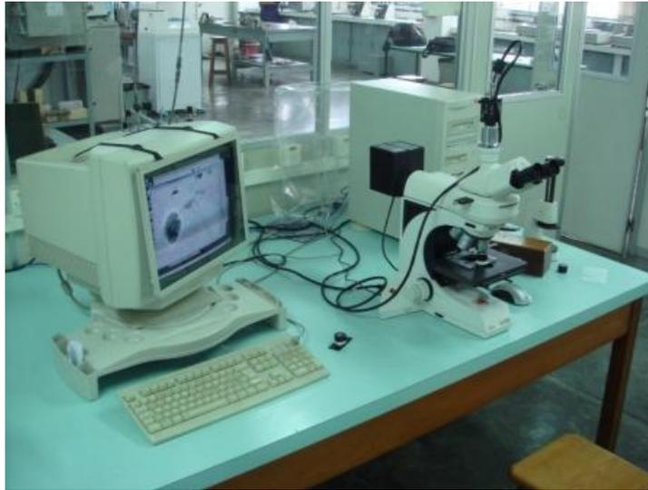
Figura 12 - Microscópio LEICA DMLM e analisador de imagens. CDMatM-FEI
