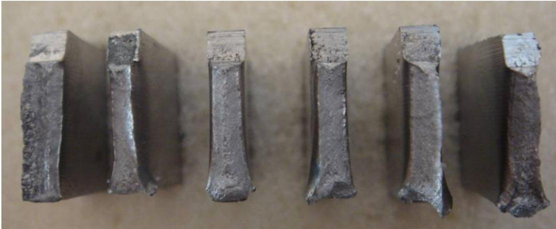
Figura 31 - Fraturas do entalhe localizado na ZTA (sem material de adição) à  $-196^{\circ}\text{C}$ ,  $-70^{\circ}\text{C}$ ,  $-30^{\circ}\text{C}$ ,  $0^{\circ}\text{C}$ ,  $23^{\circ}\text{C}$ ,  $70^{\circ}\text{C}$ .
