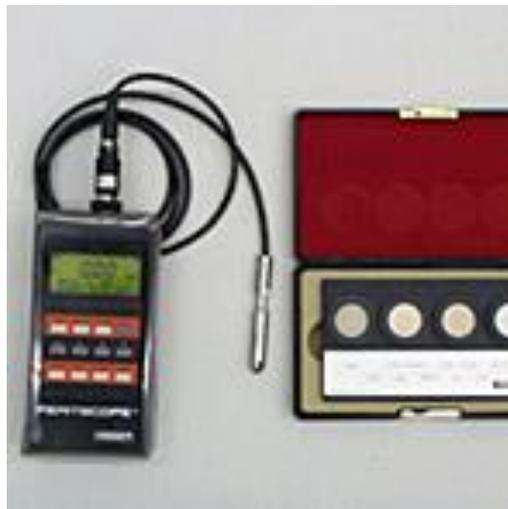
Figura 2.10 – ferritoscópio. (TAVARES, 2006)
