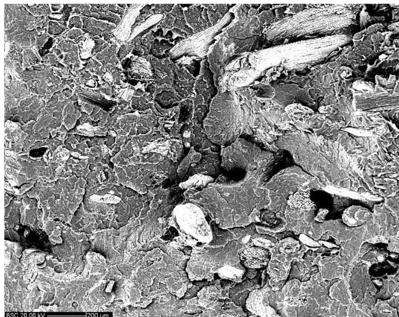
Figura 46: Fractografia no MEV da superfície fraturada no ensaio de fadiga de um corpo de prova da composição 1 (PP+20%FC+1%C) a uma tensão de 11,65 MPa. Fibras aderidas e rompidas, fibras arrancadas e vazios na matriz. Fonte: Autor.
