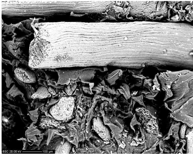
Figura 57: Fractografia no MEV da superfície fraturada no ensaio de fadiga de um corpo de prova da composição 4 (PP+40%FC+4%C) a uma tensão de 15,14 MPa. Final da fratura com maior quantidade de fibras arrancadas e vazios na matriz.
