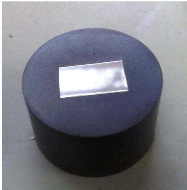
Figura 10. Amostra do aço (UNS S32750) cortado na longitudinal e embutido em resina termofixa de cura a quente (baquelite).
