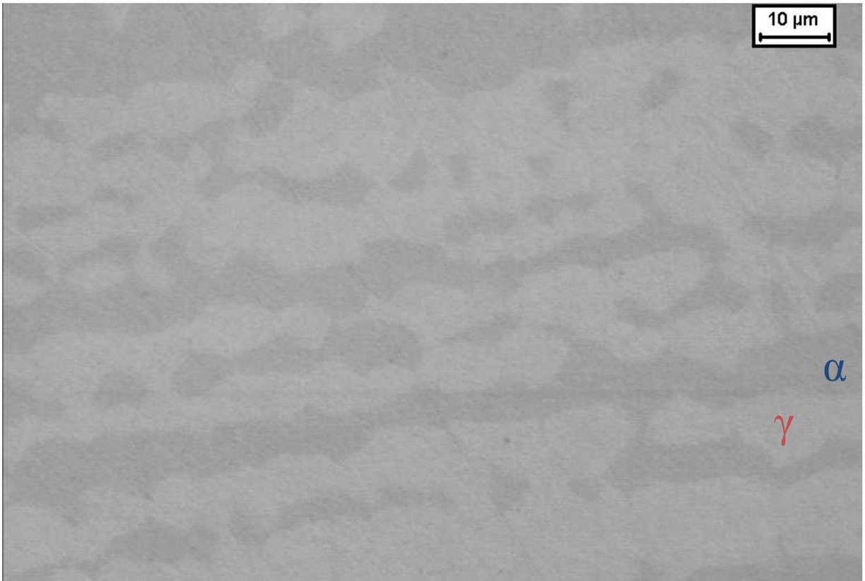
Figura 14. Amostra solubilizada com 30% de deformação. Austenita ( $\gamma$ ) e ferrita ( $\alpha$ ). Ataque: KOH.
