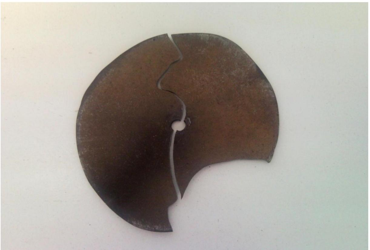
Figura 39. Amostra com 80% de deformação e envelhecida por 96h a 650°C quebrada no resfriamento.
