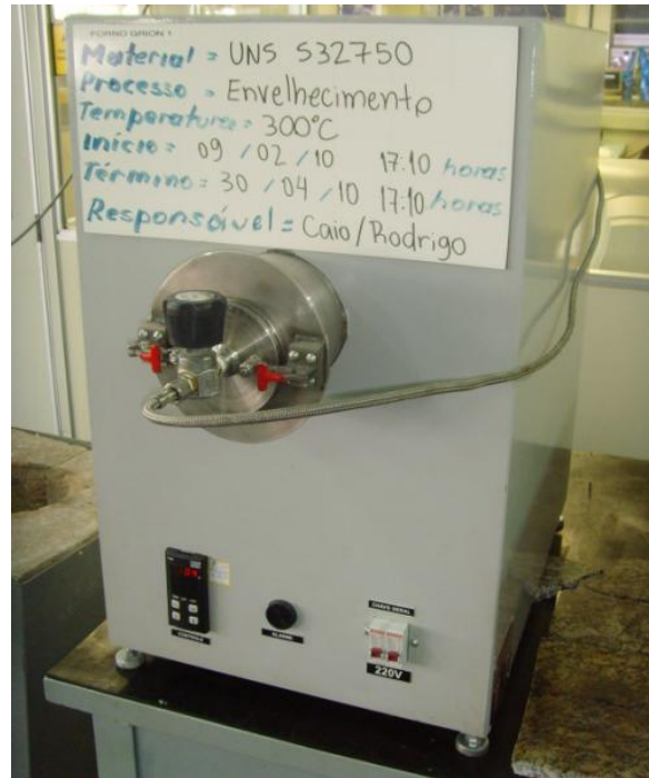
Figura 10. Um dos fornos tubulares utilizados para realização dos tratamentos térmicos.
