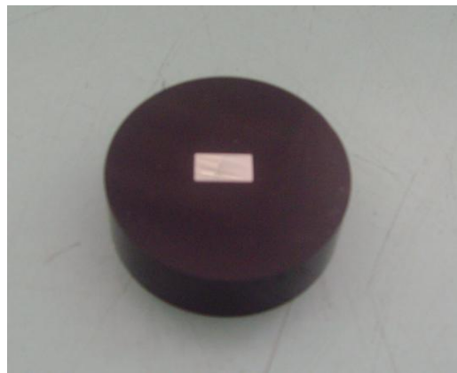
Figura 12. Amostra cortada e embutida em baquelite.
